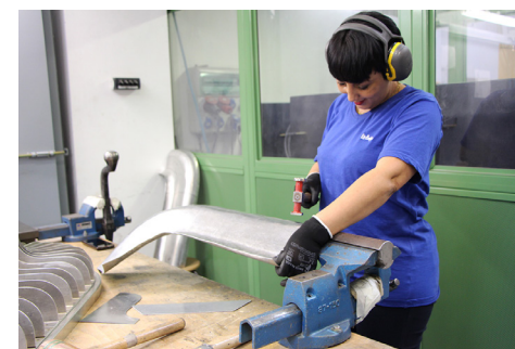
Avec son maillet, le chaudronnier réalise des pièces complexes IUMM ADOUR ATLANTIQUE
